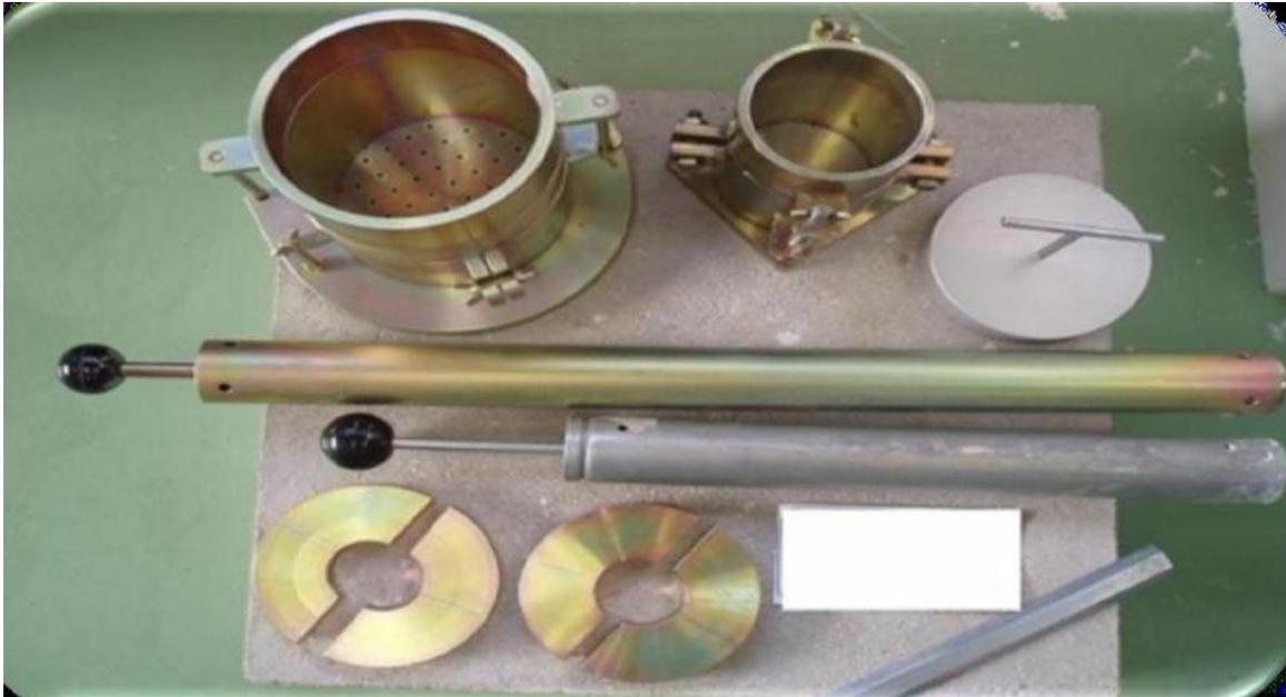
**Figure II.2. Appareillage spécifique pour essais de compactage (Proctor Normal)**
