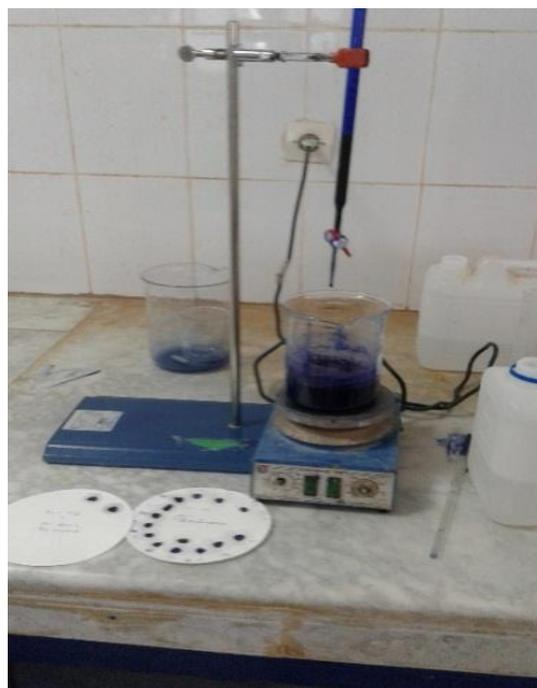
**Figure III.6.3 : Essai bleu de méthylène**
