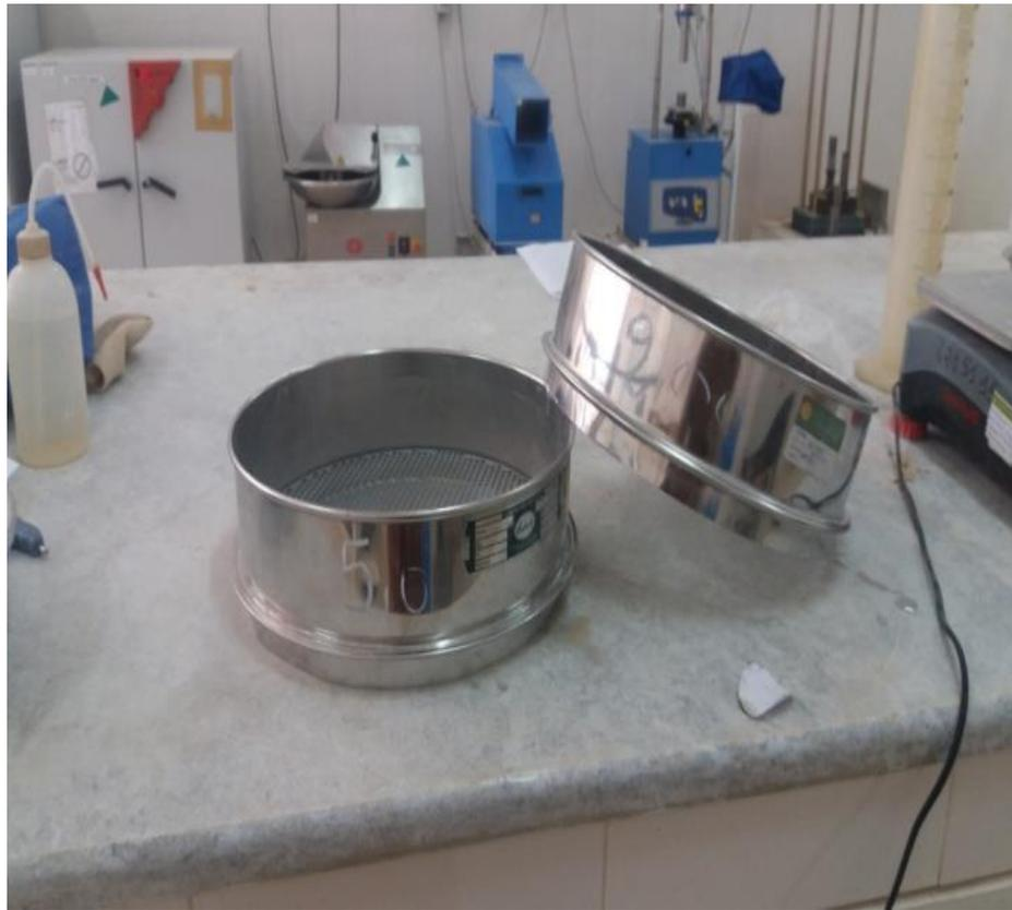
Photo.IV.1 : Un tamis d'ouverture égale à 2 mm est 5mm.
