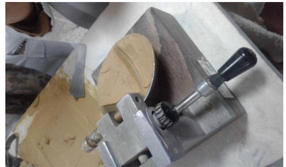
Photo III.8 : Détermination de la limite de liquidité.
