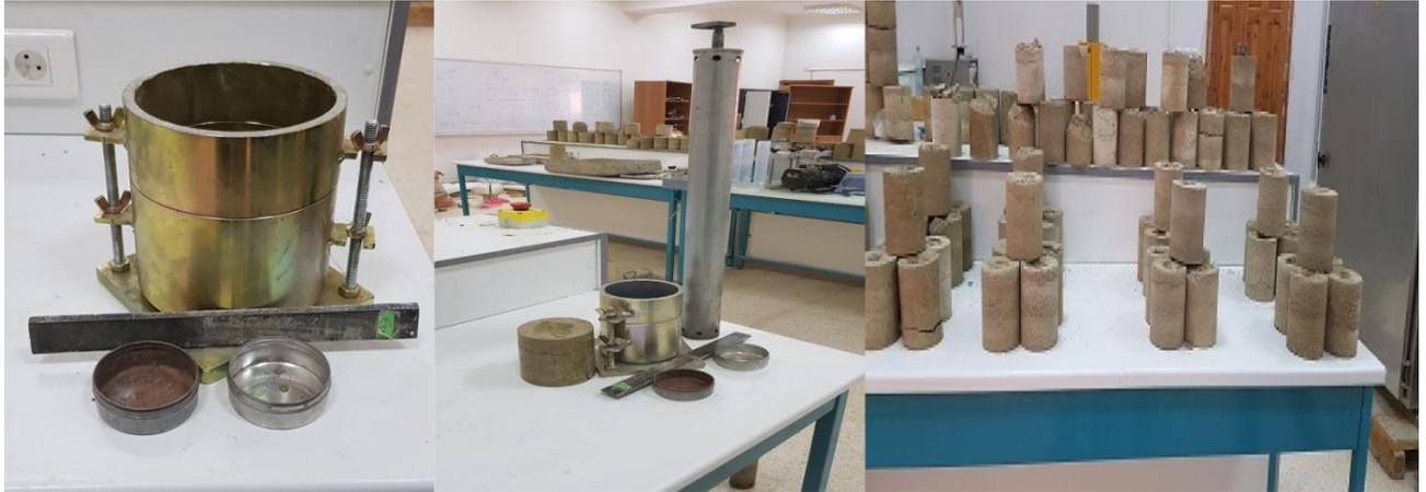
**Figure II.3. Mode opératoire de Proctor**
