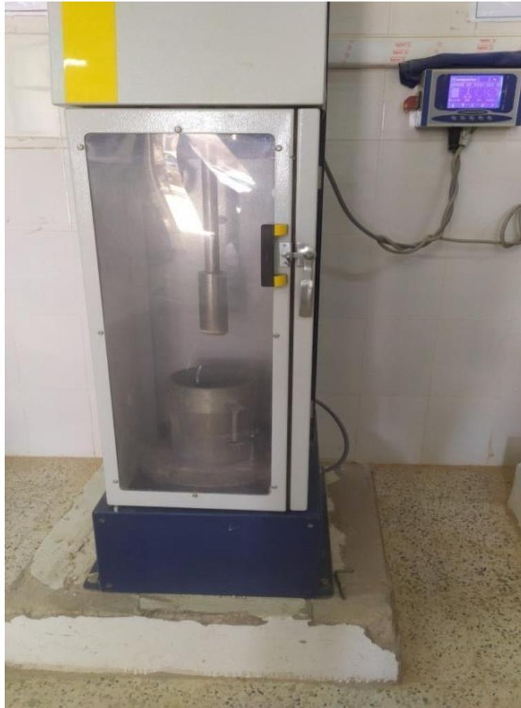
**Photo.IV.3 : Appareil de Proctor modifié automatique au laboratoire LTPS**
