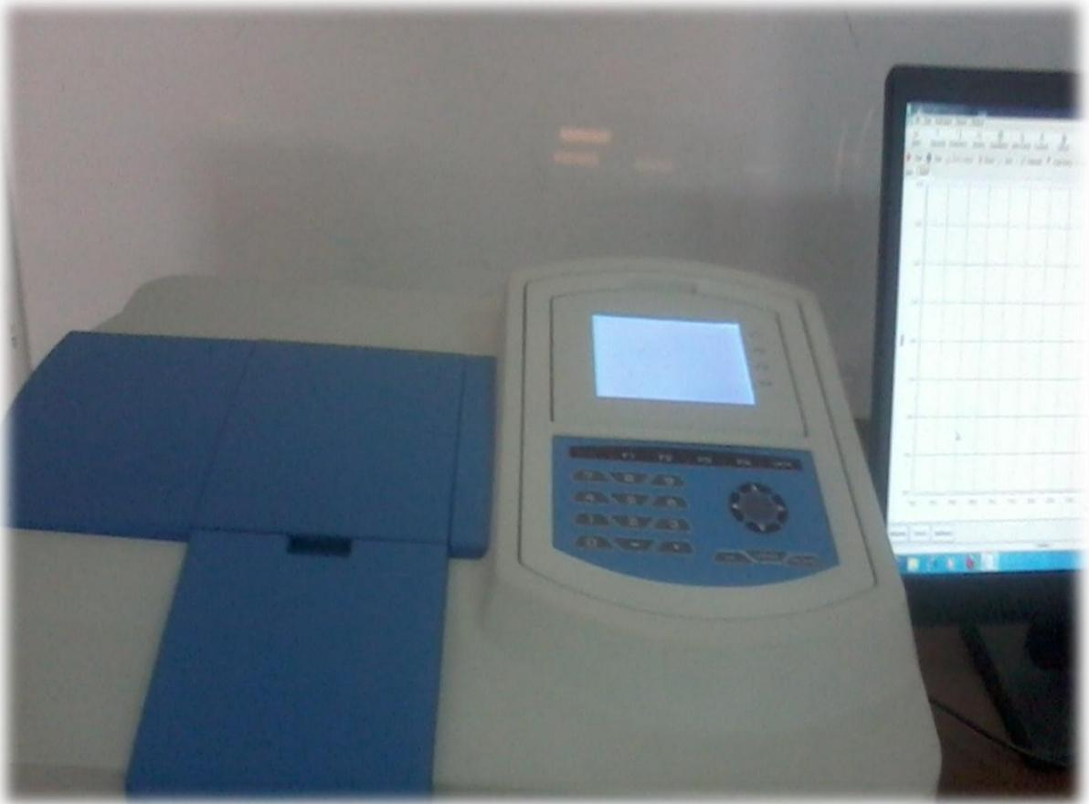
**Photo :Spectrophotomètre UV**
