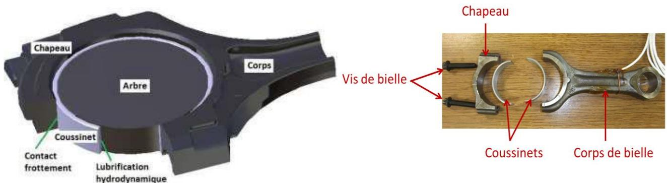
**Figure IV. 1 Bielle démontée d'un moteur automobile.[13]**
