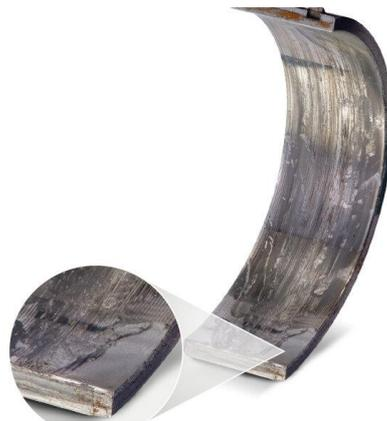
**Figure I.15** Coussinet de bielle érodé par la cavitation [5]
