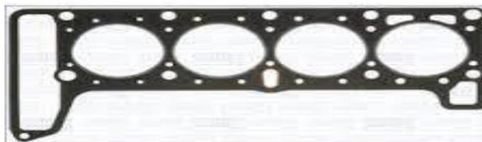
**Figure II.4 Joint du Culasse.**
