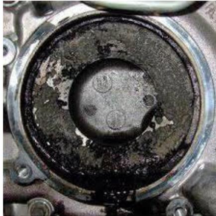
**Figure I.16 Couvercle de pompe à eau érodé par la cavitation [5]**
