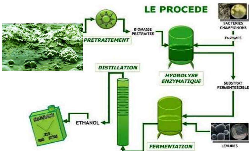
Figure 22 : Procédé de production de bioéthanol via microalgues
