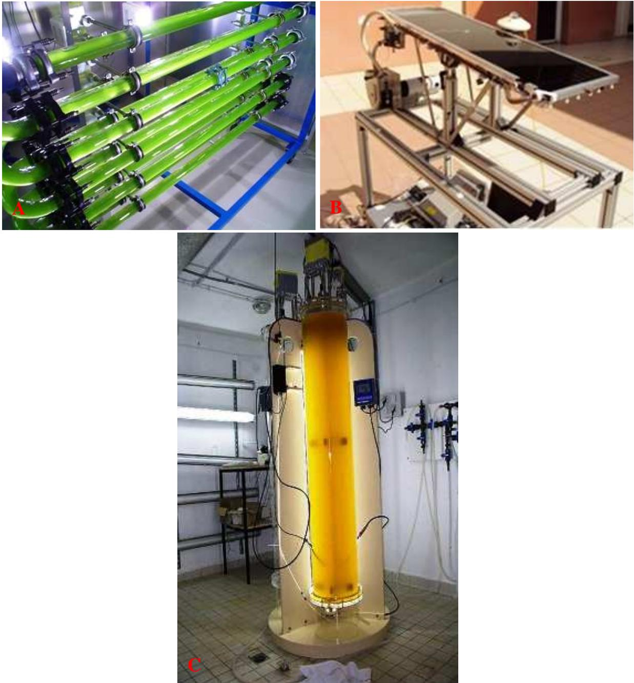
**Figure 9** : Photobioréacteur (PBR) de laboratoire pilote à éclairage externe.
