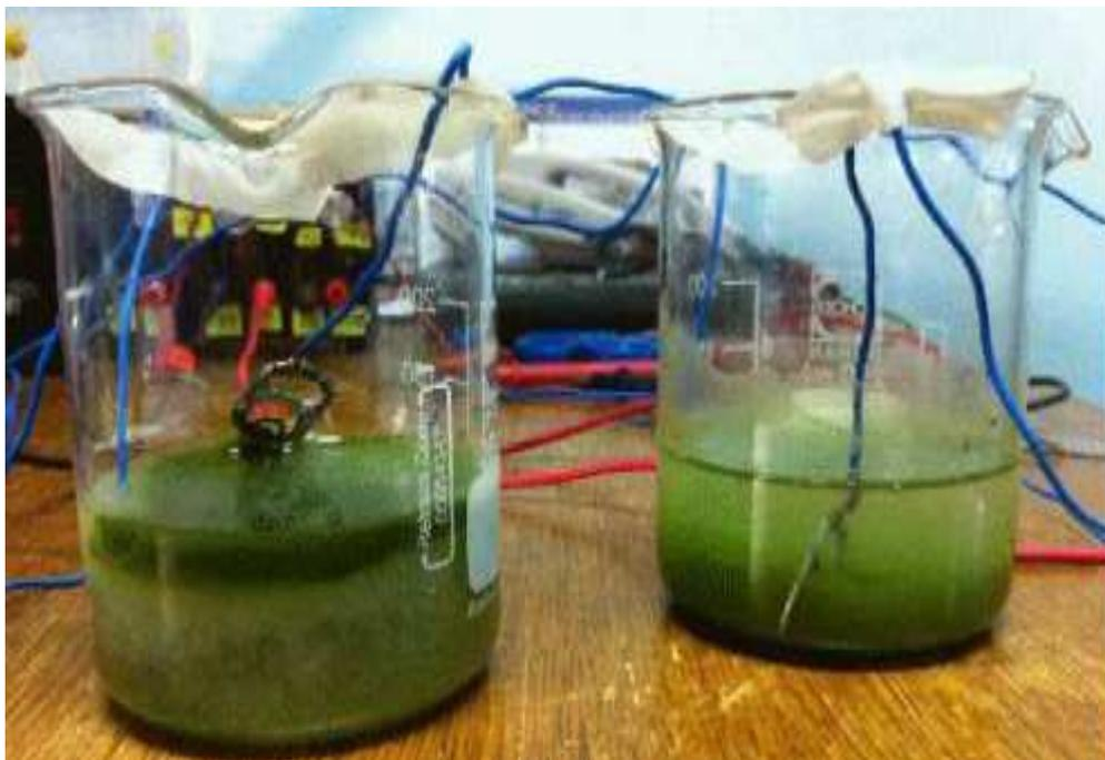
**Figure 15 :** Electrofloculation de microalgues (CABATUANDO et *al.*, 2011).
