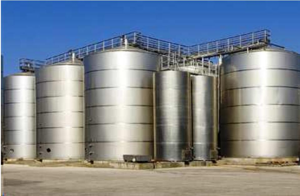
**Figure 10 :** Fermenteur de production d'Oméga-3 à partir de microalgues (FERMENATLG, 2013).
