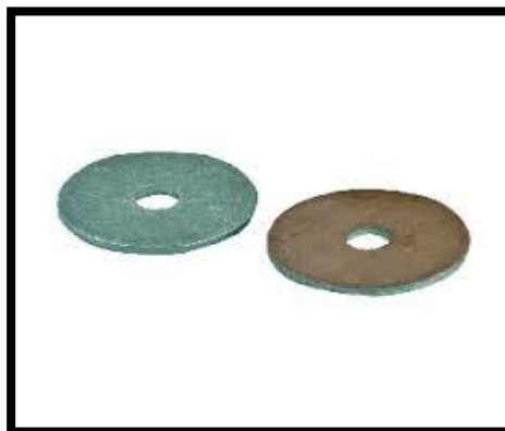
Figure I.5 : corrosion rondelle bi-métallique
