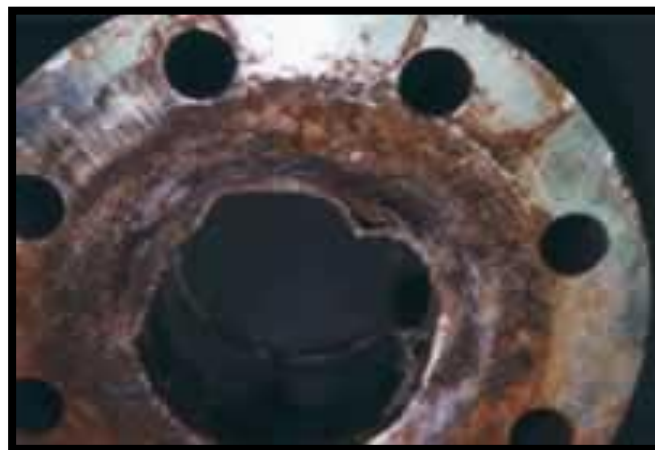
Figure I.7 :Corrosion sous contraintes d'un acier allié en milieu pechlorate
