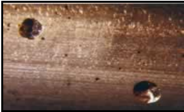
Figure I.3 : Corrosion par piqûres de divers aciers alliés dans une atmosphère soufrée.
