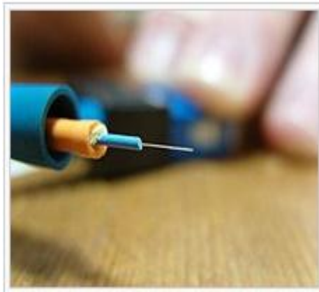
Figer (III.2) Fibremultimode utilisée dans une liaison Fibre (le connecteur SC a été retiré).
