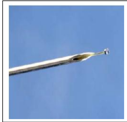
Figure (III.6) Capteur de pression optique FOP-MIV ( \varnothing 550 \mu\text{m} ) de FISO Technologies disponible commercialement pour applications médicales montré ici dans une seringue épidermique 24 gage.
