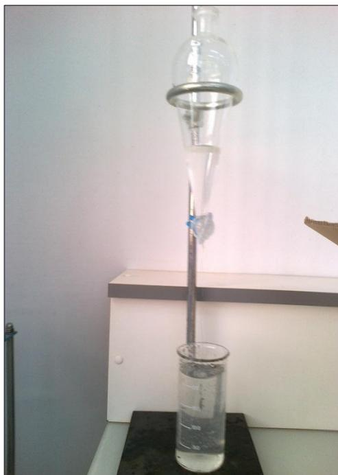
Figure 11: Ampoule de la décantation.
