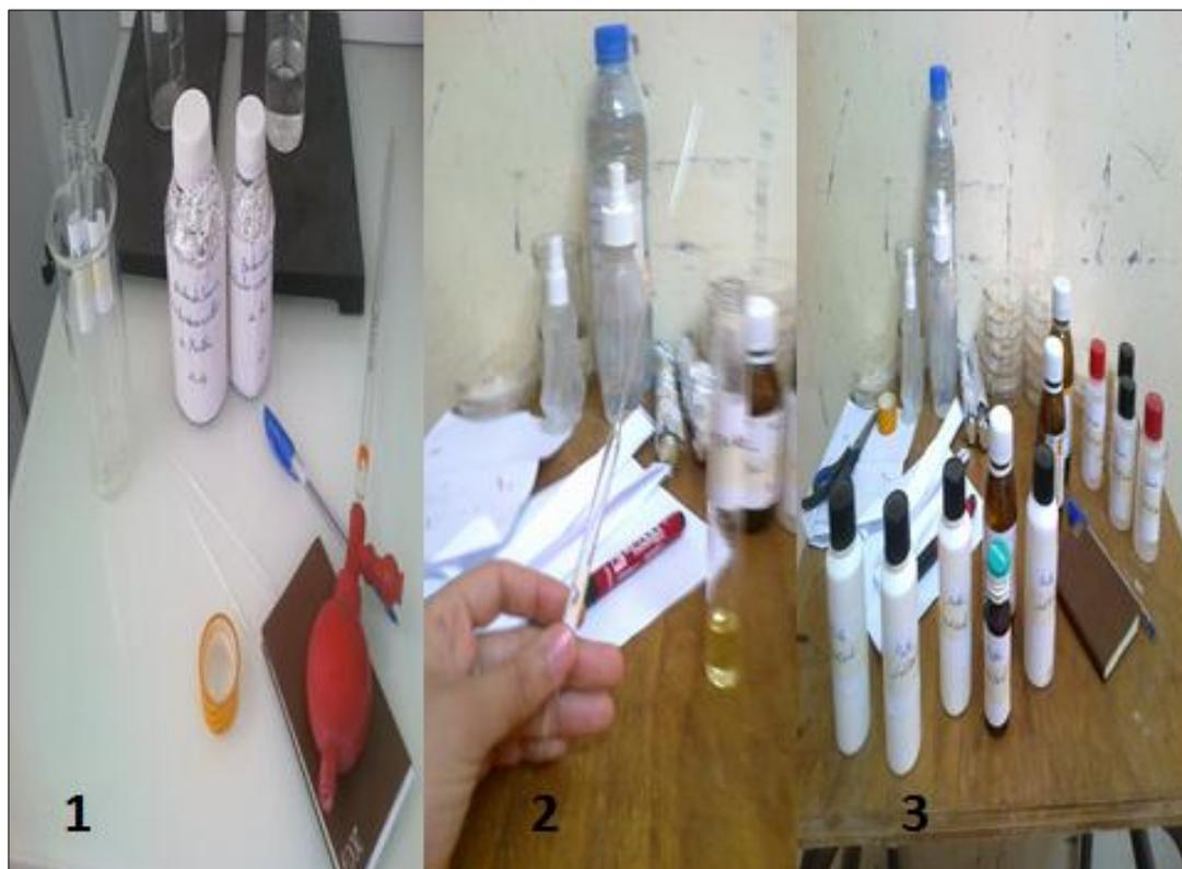
Figure 15 : Etapes de préparation les doses des EHS (1: Mettre l'HE dans des tubes à essai ; 2: retirer l'HE par la pipette pasteur ; 3: Préparer des bouteilles d' d'eau distillée).
