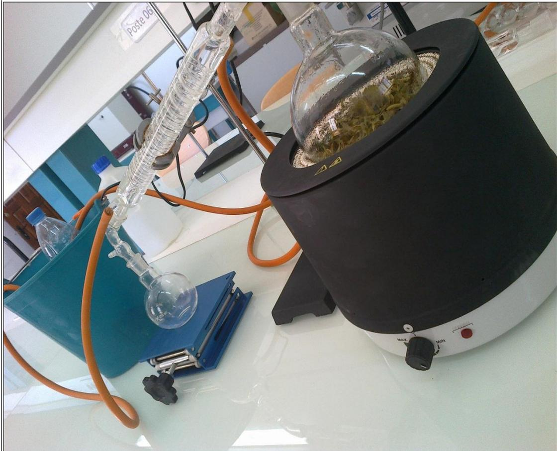
Figure 8 : Montage d'hydrodistillation des HEs.
