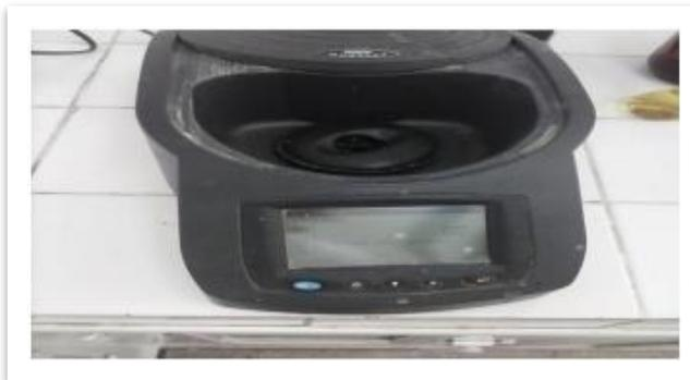
**Photo (III. 04): Spectrophotomètre UVvisible (ADE)**
