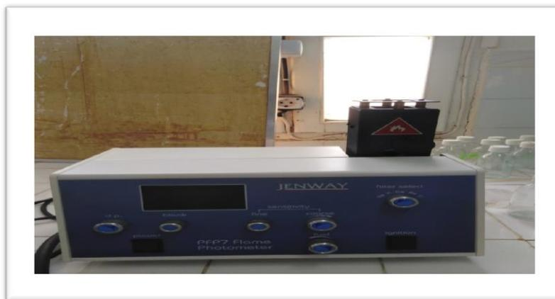
Photo N ° (III. 05): Spectromètre à flamme (JENWAY).
