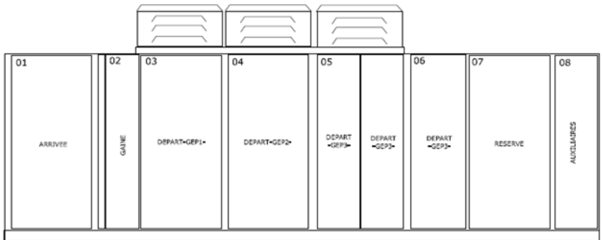
Figure 3-2 : Vue de face avant du tableau basse tension
