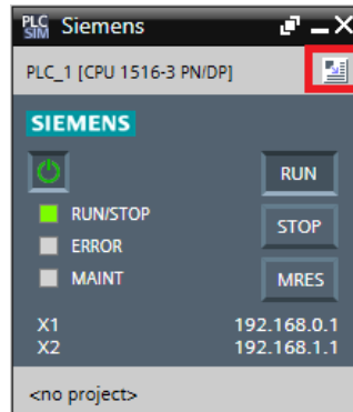
Figure 1-5 : Fenêtre du contrôleur SIMATIC PLCSIM
