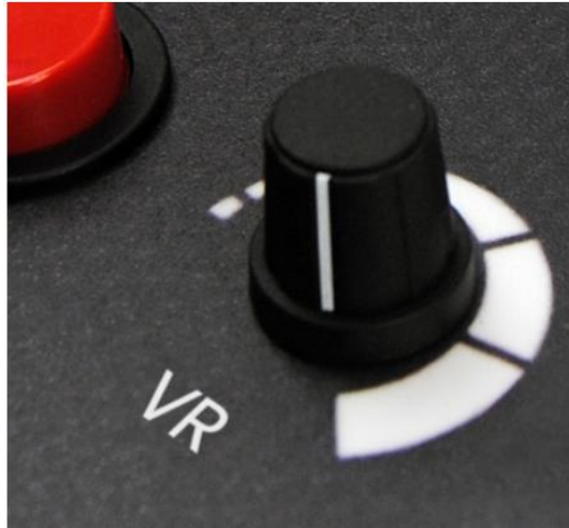
Figure II. 21: variateur de vitesse d'une bande transporteuse (VR) [10]
