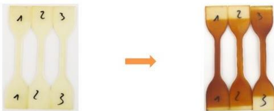
Fig 1.6: exemple de vieillissement observé sur des éprouvettes.
